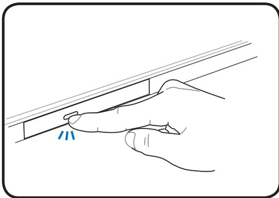
2. Nežno odprite povlecite sprednji del plošče in predal povlecite ven. Bodite previdni in se ne dotikajte leč CD pogona ali ostalih mehanizmov. Preverite, da ni nobenih ovir, ki bi se zataknele pod predal pogona.
