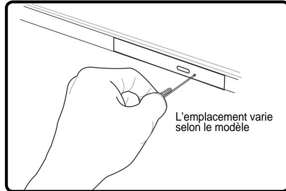
L'éjection d'urgence est une fente située sur le lecteur optique, utilisée pour éjecter le tiroir du lecteur optique lorsque l'éjection électronique ne fonctionne pas. N'utilisez pas l'éjection d'urgence à la place de l'éjection électronique. **Note: Assurez-vous de ne pas endommager l'indicateur d'activité situé dans la même zone.**
