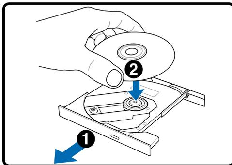
2. Retire com cuidado o painel frontal da unidade e desloque o tabuleiro completamente para fora. Certifique-se de que não tocou na lente da unidade de CD e noutros mecanismos. Certifique-se de que não há obstruções que possam bloquear o tabuleiro da unidade.
