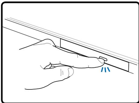
1. Com o PC Portátil desligado, prima o botão de ejeção da unidade e o tabuleiro ejecta-se parcialmente.
