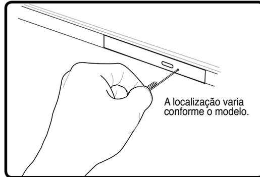
A ejeção de emergência é feita através de um orifício existente na unidade óptica e é utilizada para ejectar o tabuleiro da unidade óptica caso a ejeção electrónica não funcione. Não utilize a ejeção de emergência em vez da ejeção electrónica. **NOTA: Certifique-se de que não atinge o indicador de actividade existente na mesma área.**
