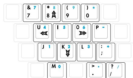
**При включеной цифровой клавиатуре**, используйте [Shift] и одну из изображенных ниже клавиш-курсоров. Например, [Shift][8] - вверх, [Shift][K] - вниз, [Shift][U] - влево, и [Shift][O] - вправо.
