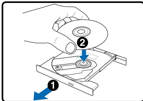
1. Когда портативный ПК включен, нажмите кнопку открывания на приводе, и его лоток будет частично вытолкнут наружу.
