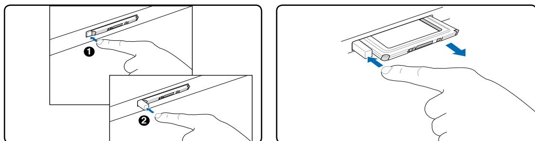
1. Нажмите и отпустите кнопку выброса. Утопленная пружинная кнопка выдвинется наружу, если ее нажать и опустить.
