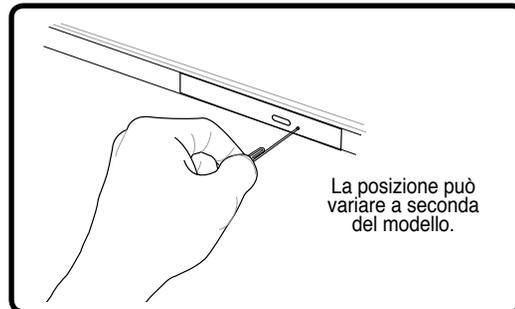
L'espulsione di emergenza è localizzata in un foro sul lettore ottico e viene utilizzata per espellere il cassetto del lettore ottico nel caso in cui l'espulsione elettrica non dovesse funzionare. Non utilizzare l'espulsione di emergenza al posto dell'espulsione elettronica. **NOTA: Assicurarsi di non danneggiare l'indicatore di attività situato nella stessa zona.**
