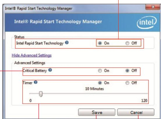
點選以啟動計時器。當此功能啟動後，移動捲軸至所要的時間。當系統閒置超過您所設定的時間，系統會自動進入 Intel® Rapid Start 模式。預設時間為 10 分鐘
