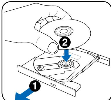
步驟三：一手將光碟片輕輕壓入托盤定位，另一手請輕扶著托盤。確定光碟片置放定位後，再將托盤輕輕推入插槽中。
