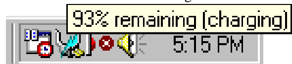
Energiesymbol bei Verwendung von Netzstrom. Das Lade-(Blitz-)Symbol erscheint über dem Stecker-Symbol, wenn der Akku nicht voll geladen ist. Wenn er voll geladen ist, bleibt nur das Steckersymbol sichtbar.
