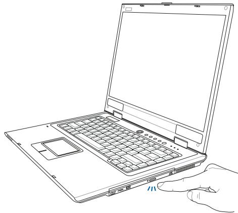
步骤二：请将光驱托盘完全拉出。将光盘印刷面朝上轻轻置入托盘中央，避免刮伤光盘数据面。
