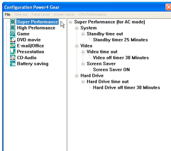
在 Windows XP 桌面上的「开始」选单中有一项功能是「PMode Config」，选择该项目出现如左图窗口，可以切换屏幕分辨率。当您在演示时，按下性能设置快捷键切换到演示模式，也会出现如左图窗口，快速切换到适当之显示分辨率。
