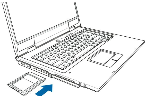
步骤二：插入PC卡之后，假如该PC卡附有接口，请将连接线插头插入PC卡。
