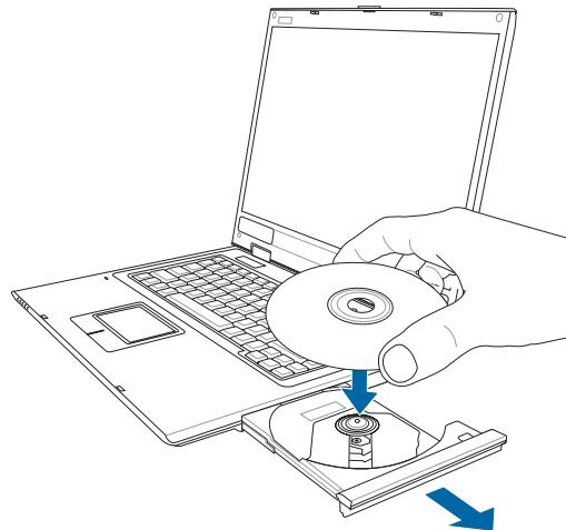
步骤三：一手将光盘轻轻压入托盘定位，另一手请轻扶著托盘。确定光盘置放定位后，再将托盘轻轻推入插槽中。
