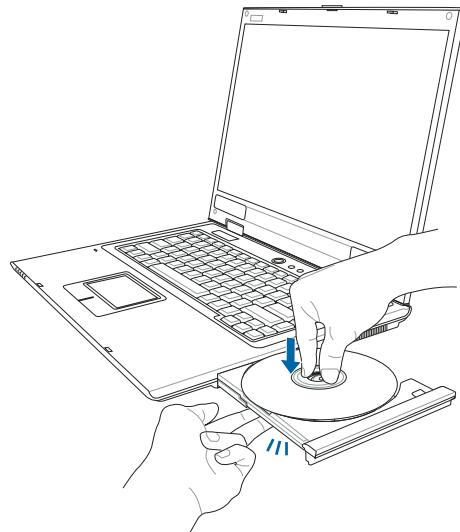
步骤四：欲取出光盘，使用中指按住光驱托盘中央轴承，食指将光盘边缘向上拨动即可取出。
