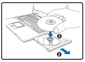
2. ドライブのフロントパネルをそっと 引っ張りながらながら、トレイをスラ イドさせて完全に出します。光学ドラ イブのレンズや他の機械部分には触れ ないように注意してください。ドライ ブのトレイの下に邪魔になる物体がな いことを確認してください。
