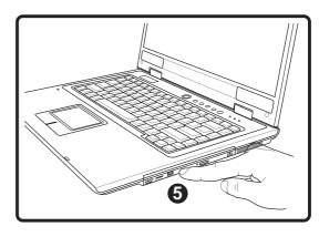
4. ドライブのトレイをゆっくり元に戻します。ドライブはディスクのコンテンツ(TOC)のテーブルの読み込みを開始します。ドライブが停止したら、ディスクを使用できるようになりました。
