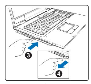
1. トグルエジェクトボタンを押して、離し ます。引っ込んでいるバネ式トグルボタ ンは、押して離すと飛び出てきます。
