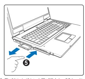
2. 飛び出したボタンを再び押すと、PCカード が半分ほど出てきます。注意してソケット から引っ張るようにして出します。
