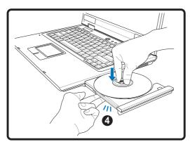
3. ディスクの端を持ちディスクの印刷された面を上に向けます。ディスク中央部の両端がハブにパチンと留まるまで押します。正しく取付けられると、ハブはディスクより高くなります。
