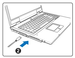
3. PCカードに必要なケーブルやアダプタ を注意して接続します。一般に、コネ クタは一方向にしか挿入できません。 コネクタの面にあるスティッカ、アイ コン、マーキングのある方が表です。
