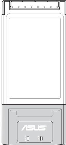
La carte **ASUS WLAN PC Card (WL-107g)** est une carte LAN sans fil qui s'insère dans le connecteur PCMCIA Type II du portable pour supporter un réseau sans fil utilisant le standard IEEE 802.11g/b.
