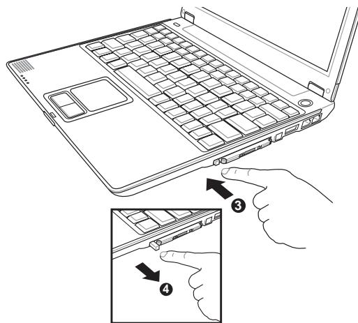
飛び出したボタンを再び押すと、PCカードが半分ほど出てきます。注意してソケットから引っ張るようにして出します。
