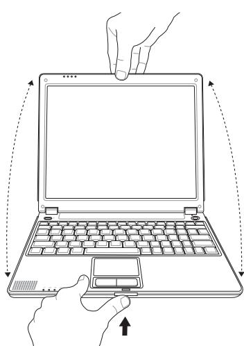
表示のリリースボタンを押して、システムの部分を一方の手で押しながら、表示パネルを他方の手で持ち上げます
