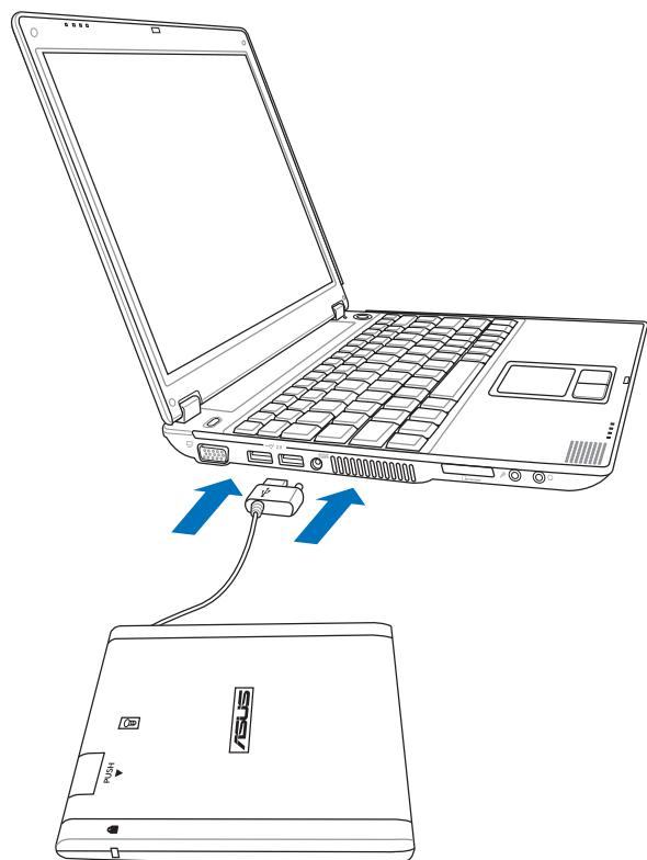
**モデル2：** DC電源インレットを搭載したUSB。これはこのノートPCでのみ作動する当社独自の設計ですが、光学ディスクドライブまたはハードディスクドライブモジュールが要求する十分な電力を提供します。
