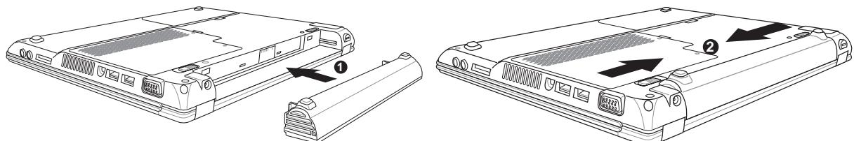
(1) クリック音が鳴るまでバッテリパックを挿入します。
