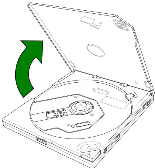
1. ドライブのトップのカバー パネルの[停止/開く]ボタンを押して、トップ カバーを開きます。
