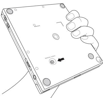
1. 外部オプティカルドライブを持ち上げて、上下裏返してドライブの底が上に来るよう配置します。マニュアルでイジェクトをスライドさせてトップカバーを開放します。
