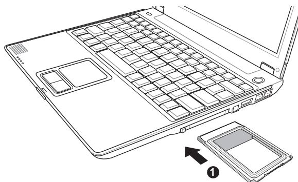
PCカードに必要なケーブルやアダプタを注意して接続します。一般に、コネクタは一方向にしか挿入できません。コネクタの面にあるスティック、アイコン、マーキングのある方が表です。
