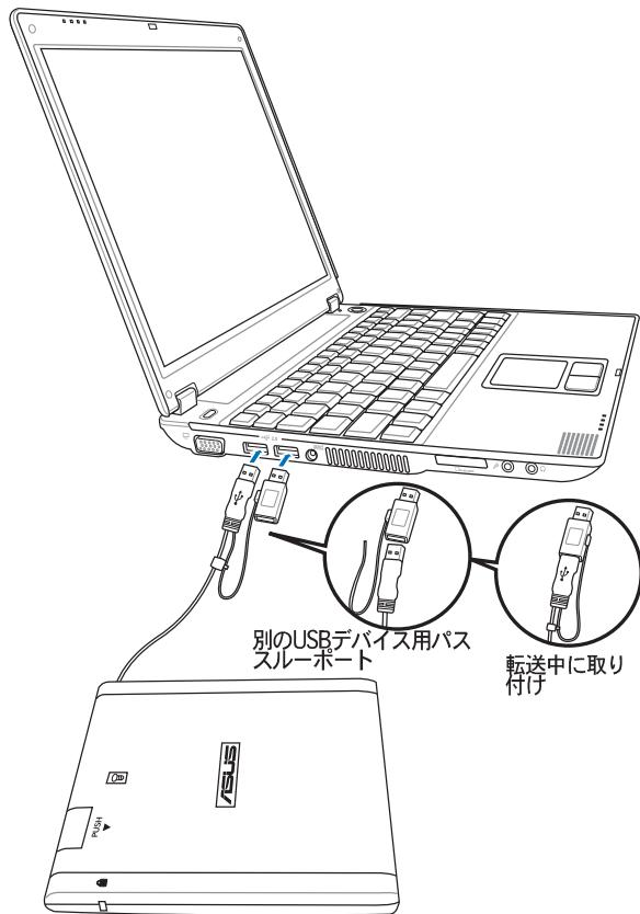
**モデル1：** ハードディスクドライブモジュール用のデュアルUSB。この設計は、他のコンピュータでも使用できます。
