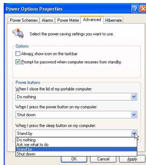
「休止状態」はサスペンドトゥラム(STD)と同じで、ハードディスクドライブに現在のデータと状態を保存します。このオプションによって、RAMを周期的にリフレッシュする必要がなくなり、消費電力は大幅に抑えられます。LANやモデムのような一部の呼び起こしコンポーネントに電力を供給する必要があるため、完全にオフにはされません。「休止状態」は「スタンバイ」よりも多くの電力を保存します。操作方法：「パワーオプション」で休止状態を有効にし、を選択します。[スタート] | [シャットダウン]、[休止状態] を選択します。
