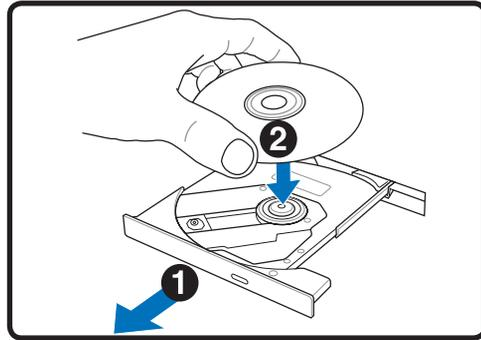
2. Tire suavemente del panel frontal de la unidad y deslice la bandeja hacia fuera todo el recorrido. Tenga cuidado de no tocar la lente óptica del unidad y otros mecanismos. Asegúrese de que no hay objetos que puedan quedar atascados bajo la bandeja de la unidad.
