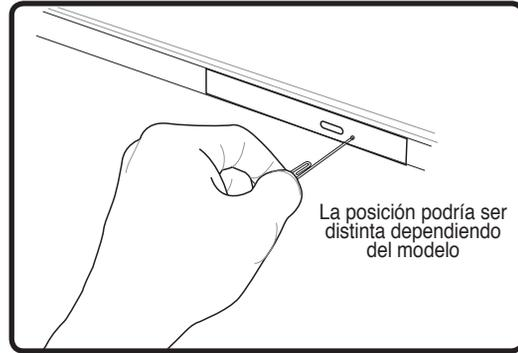
El sistema de expulsión de emergencia está localizado en un agujero en la unidad óptica y se utiliza para expulsar la bandeja de la unidad óptica en caso de que la expulsión electrónica no funcione. No utilice la expulsión de emergencia en lugar de la expulsión electrónica. **Nota: Asegúrese de no pinchar el indicador de actividad localizado en la misma área.**
