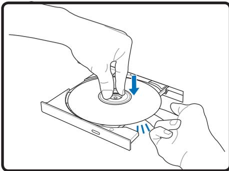
3. Sujete el disco por los bordes y coloque el disco con la cara impresa hacia arriba. Empuje la bandeja desde ambos lados del orificio central hasta que entre en el soporte con un chasquido. **Cuando el disco quede correctamente colocado, el soporte central debe sobresalir del disco.**
