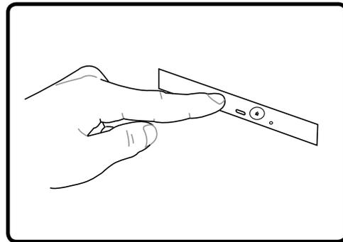
3. Prenez le disque par les côtés, face imprimée vers le haut. Appuyez des deux côtés du centre du disque jusqu'à ce qu'il s'enclenche sur le moyeu. **Le moyeu doit être plus haut que le disque lorsqu'il est correctement installé.**
