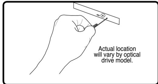
L'éjection d'urgence est située dans une ouverture sur le lecteur optique, et sert à éjecter le tiroir du lecteur lorsque l'éjection électronique ne fonctionne pas. N'utilisez pas l'éjection d'urgence à la place de l'éjection électronique. **Note: Faites attention à ne pas érafler le témoin d'activité qui est situé dans la même zone.**
