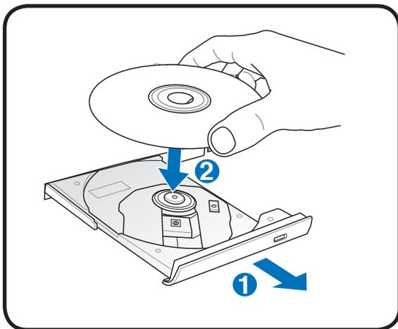
3. Sujete el disco por los bordes y coloque el disco con la cara impresa hacia arriba. Empuje la bandeja desde ambos lados del orificio central hasta que entre en el soporte con un chasquido. **Cuando el disco quede correctamente colocado, el soporte central debe sobresalir del disco.**
