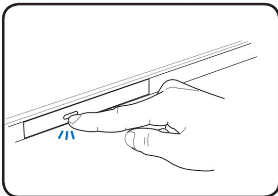
2. Tire suavemente del panel frontal de la unidad y deslice la bandeja hacia fuera todo el recorrido. Tenga cuidado de no tocar la lente óptica de la unidad ni el resto de mecanismos. Asegúrese de que no hay objetos que puedan quedar atascados bajo la bandeja de la unidad.
