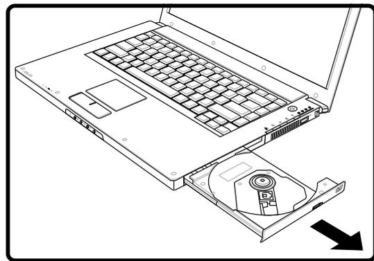
3. Prenez le disque par les côtés, sa face imprimée vers le haut. Appuyez des deux côtés du centre du disque jusqu'à ce qu'il s'enclenche sur le moyeu. **Le moyeu doit être plus haut que le disque lorsqu'il est correctement installé.**
