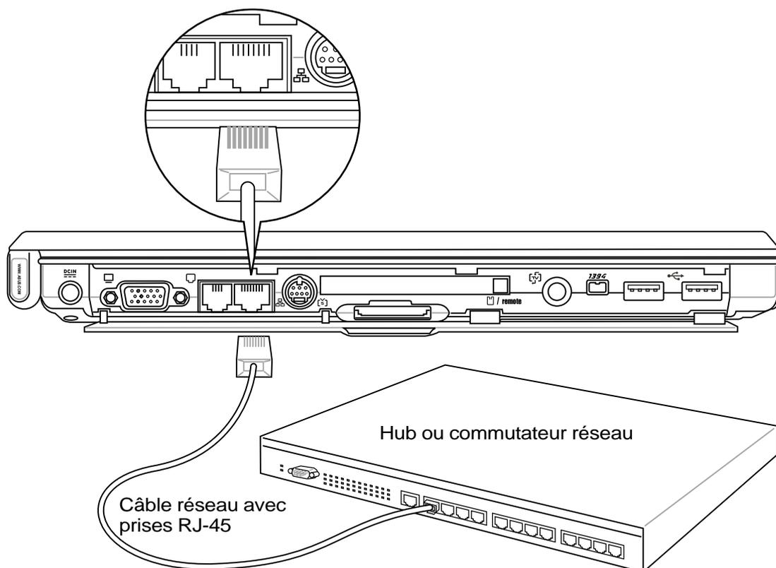
Ceci est un exemple du portable connecté à un hub ou un commutateur réseau pour utiliser avec le contrôleur Ethernet intégré.
