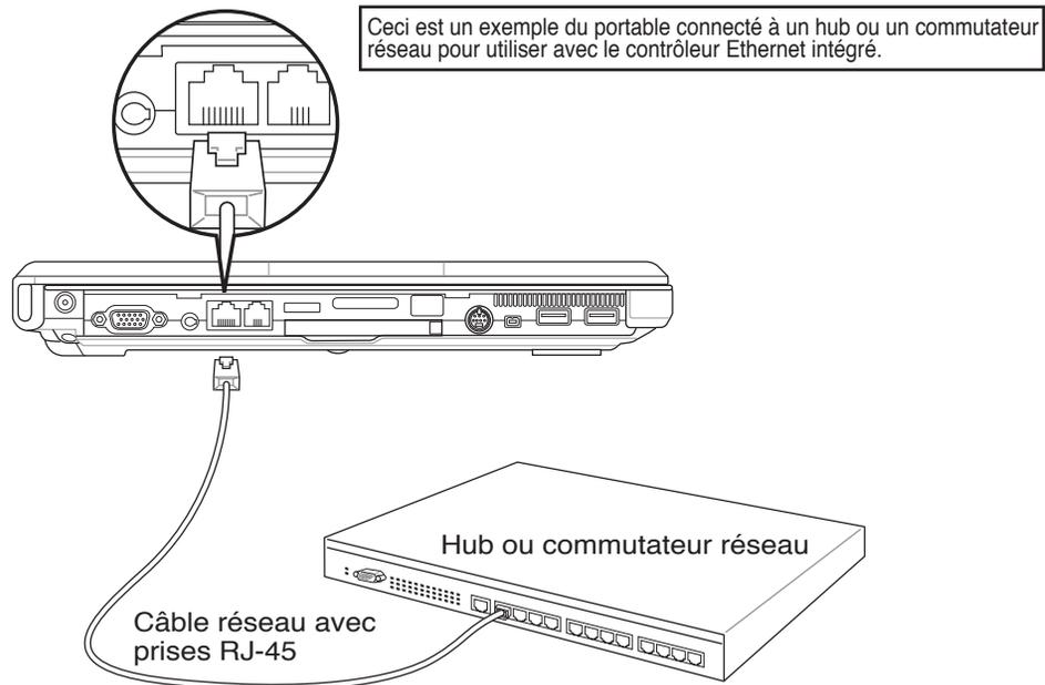
🖋️ **NOTE: Ni le modem ni le contrôleur réseau intégrés ne peuvent être installés après l'achat. Ils peuvent toutefois être installés sous forme de carte PC (PCMCIA)**
