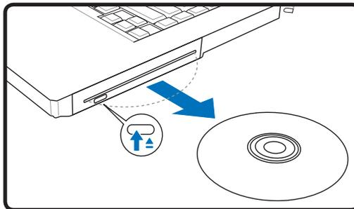
1. Alors que le portable est allumé, pressez le bouton électronique d'éjection (ou utiliser la fonction éjecter sous Windows)
