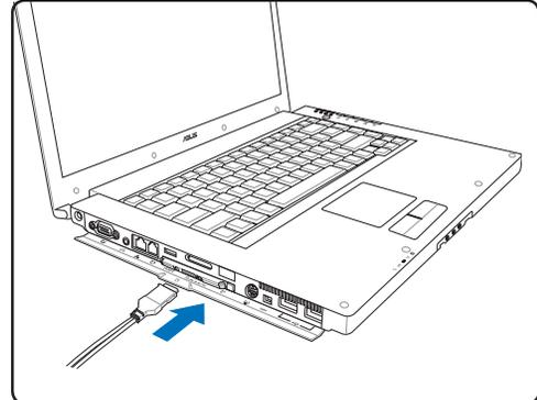
3. Schliessen Sie alle Kabel oder Adapter für die PC Card sorgfältig an. Normalerweise können Anschlüsse nur in eine Richtung eingesetzt werden. Achten Sie auf Etiketten, Symbole oder Markierungen auf einer Seite des Anschlusses, welche die Oberseite darstellen.
