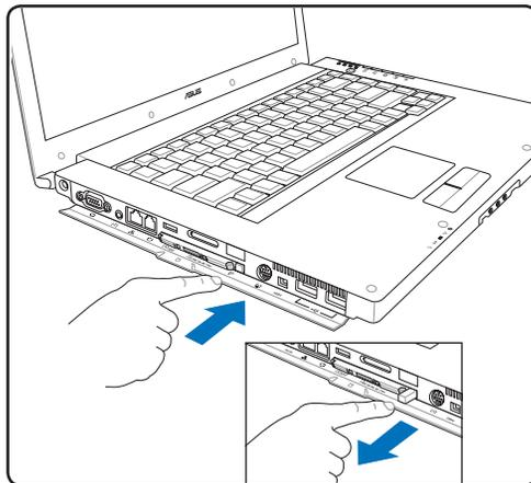
1. Drücken Sie die Auswurfaste hinein und lassen sie wieder los. Die Federtaste kommt heraus, wenn sie hineingedrückt und wieder losgelassen wird.
