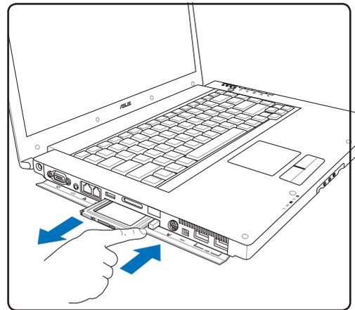
2. Drücken Sie die herausragende Taste erneut, um die PC Card herauszuholen. Ziehen Sie die herausragende PC Card sorgfältig aus dem Steckplatz.
