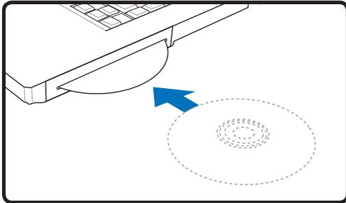
1. Schieben Sie bei eingeschaltetem Notebook die Disk langsam in den Schlitz, bis sie vom Laufwerk angenommen wird.
