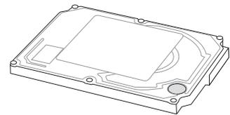
**VORSICHT! Unsachgemäßer Umgang während des Transports kann das Festplattenlaufwerk beschädigen. Gehen Sie mit dem Notebook sorgsam um und halten es von statischer Elektrizität und starken Vibrationen oder Stößen fern. Das Festplattenlaufwerk ist die empfindlichste Komponente des Notebooks und wird am ehesten beschädigt, wenn das Notebook fallengelassen wird.**
