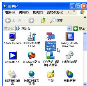
▲具备TPM安全芯片的机型，可以在控制面板看到Infineon Security Platform程序。
