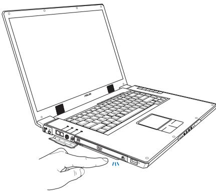
步骤一：按下光驱前方之托盘退出钮，光驱将略微弹出。
