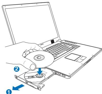
步骤二：请依照上图箭头1的方向将光驱托盘完全拉出。将光盘印刷面朝上依照箭头2所示轻轻置入托盘中央，避免刮伤光盘资料面。
