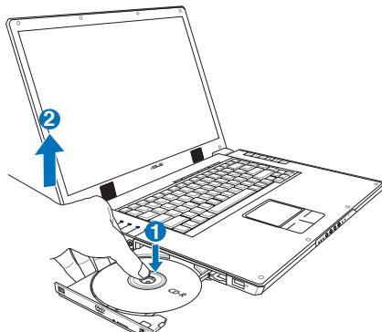
步骤四：如欲取出光盘，使用中指照箭头1的方向按住光驱托盘中央轴承，食指将光盘边缘照箭头2的方向向上拨动即可取出。
