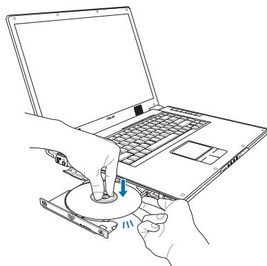
步骤三：一手请轻扶着托盘，另一手将光盘轻轻压入托盘定位。确定光盘置放定位后，再将托盘轻轻推入插槽中。
