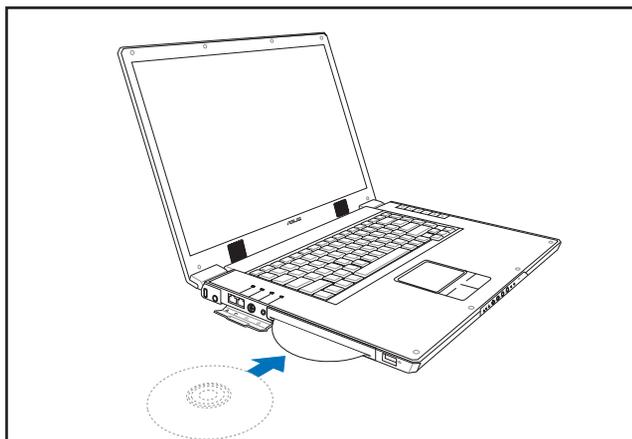
步驟一：在系統開機的情況下，將光碟片輕輕地置入光碟片插槽，接著緩緩地將光碟片推入光碟機中，當光碟片僅剩三分之一露出主機外時，系統便會自動地將光碟片吸入。
