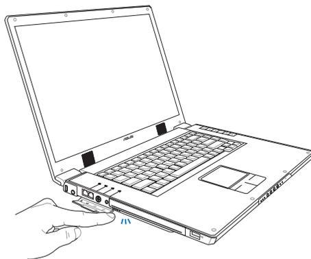
步驟二：如欲取出光碟片，請以手指壓下光碟片退出鈕，稍待片刻後光碟機便會自光碟片插槽將光碟片退出。在光碟片推出後，您只要直接將光碟片自光碟置入口中平行取出即可。
