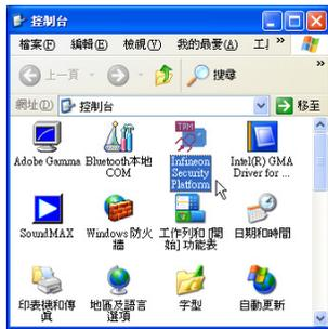
▲具備TPM安全晶片的機型，可以在控制台看到Infinion Security Platform程式。
