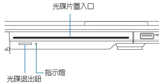
在本光碟機上的左下角有一個光碟退出鈕（參考上圖），當您要從光碟機中退出光碟片時，只要按下此按鈕便可使光碟片從光碟片置入口退出，您只要在光碟片退出後，直接將光碟片抽出即可。
