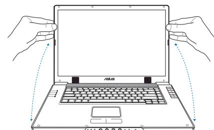
電源開關僅在打開液晶螢幕上蓋之後才有作用，尚未打開液晶螢幕上蓋前無法開啓電源。
