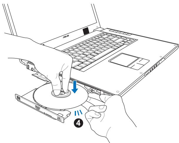
步驟四：如欲取出光碟片，使用中指照箭頭5的方向按住光碟機托盤中央軸承，食指將光碟片邊緣照箭頭6的方向向上撥動即可取出。
