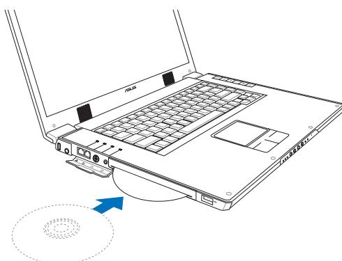
步驟二：如欲取出光碟片，請以手指壓下光碟退出鈕，稍待片刻後光碟機便會自光碟片置入口將光碟片退出。在光碟片推出後，您只要直接將光碟片自光碟置入口中抽出即可。
