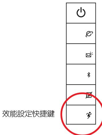
當您外出使用筆記型電腦時，電池的使用時間長短成為一個很重要的功能，本產品除了提供長效的電池之外，更精心設計了一個效能設定快捷鍵，讓您輕鬆的達到省電的目的。
