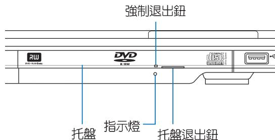
本光碟機上有一個托盤退出鈕（參考上圖），托盤退出鈕旁邊有一個小孔為強制退出鈕，當您無法正常打開光碟機托盤取出光碟片時，可使用一根扳直的回紋針插入小孔內退出光碟機托盤。當光碟機存取中，光碟機存取指示燈閃爍，表示光碟機正在存取動作中。
