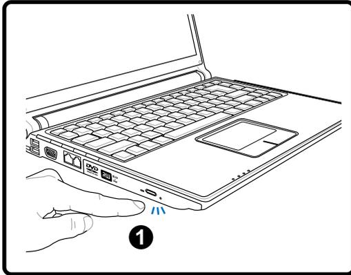
1. Drücken Sie bei eingeschaltetem Notebook die Auswurf-taste, fährt der Laufwerksträger ein Stück aus.
