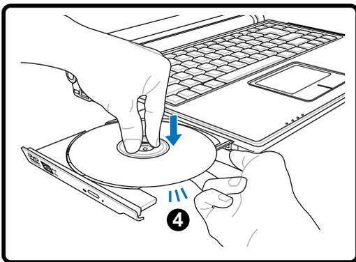
3. ディスクの端を持ちディスクの印刷された面を上に向けます。ディスク中央部の両端がハブにパチンと留まるまで押します。正しく取付けられると、ハブはディスクより高くなります。
