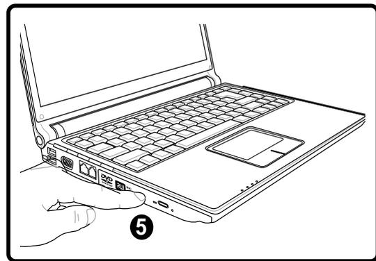
4. ドライブのトレイをゆっくり元に戻します。ドライブはディスクのコンテンツ(TOC)のテーブルの読み込みを開始します。ドライブが停止したら、ディスクを使用できるようになりました。
