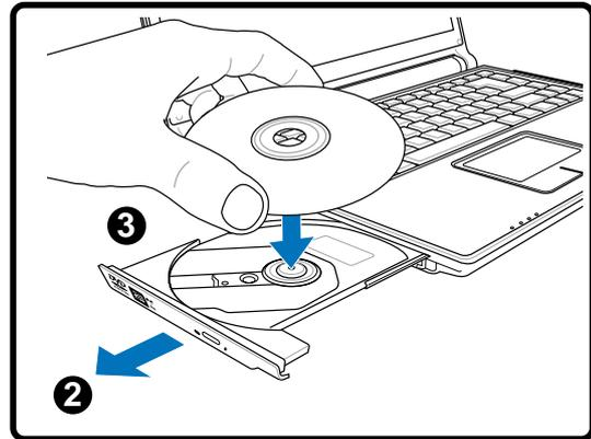
2. ドライブのフロントパネルをそっと引っ張りながら、トレイをスライドさせて完全に出します。光学ドライブのレンズや他の機械部分には触れないように注意してください。ドライブのトレイの下に邪魔になる物体がないことを確認してください。
