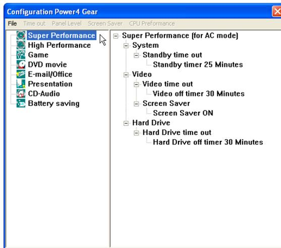
在Windows XP桌面上的「開始」選單中有一項功能是「PMode Config」，點選該項目出現如左圖視窗，可以切換螢幕解析度。當您在簡報時，按下效能設定快捷鍵切換到簡報模式，也會出現如左圖視窗，快速切換到適當之顯示解析度。
