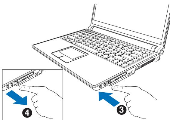
步驟四：再將退出鈕向PC卡插槽方向壓入，PC卡隨即退出。
