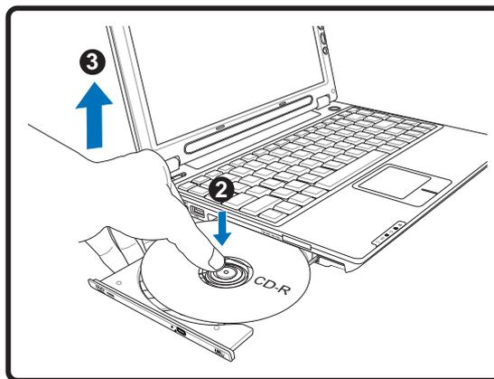
2. Tout en appuyant sur la fixation centrale, forcez doucement l'arête du disque vers le haut avec un angle pour enlever le disque de la fixation centrale.
