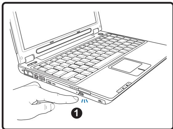
1. Lorsque le portable est allumé, pressez le bouton d'éjection du lecteur de disque. Le tiroir s'éjecte partiellement.
