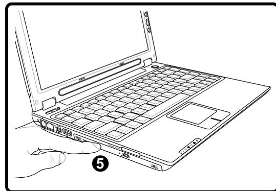
4. Drücken Sie den Laufwerkträger langsam wieder hinein. Das Laufwerk liest jetzt das Inhaltsverzeichnis auf der Disk. Wenn das Laufwerk stoppt, kann die Disk verwendet bzw. abgespielt werden.
