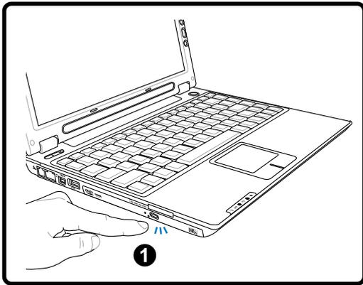
1. Drücken Sie bei eingeschaltetem Notebook die Auswurf-taste, fährt der Laufwerkträger ein Stück aus.
