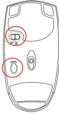
1. 开启蓝牙鼠标底部开关，再按下Reset键，清除可能已存在的连接设置。
