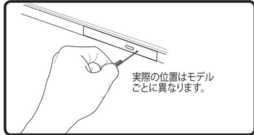
緊急イジェクトは光学ドライブにある穴の中にあり、電子イジェクトが利用できない際に使用します。緊急イジェクトを電子イジェクトの代用とはしないでください。**注: アクティビティインジケータを傷つけないように注意してください。**
