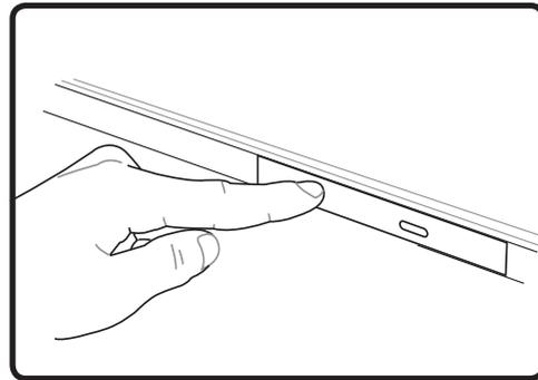
4. ドライブのトレイをゆっくり元に戻すと、ドライブはディスクのコンテンツ(TOC)のテーブルの読み込みを開始します。ドライブが停止したら、ディスクを使用できます。
