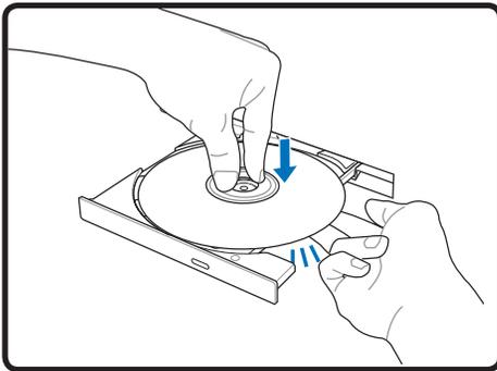
3. ディスクの端を持ちディスクの印刷面を上に向けます。ディスク中央部の両端がハブにパチンと留まるまで押します。正しく取付けられると、ハブはディスクより上に出ます。
