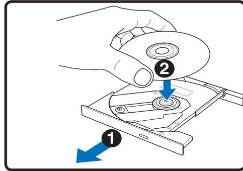
2. ドライブのフロントパネルをそっと引きながら、トレイをスライドさせて完全に出します。光学ドライブのレンズや他の機械部分には触れないように注意してください。ドライブのトレイの下に障害物がないことを確認してください。
