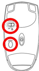
2. Impostare su ON (Attivo) l'interruttore d'alimentazione sulla parte inferiore del mouse.
