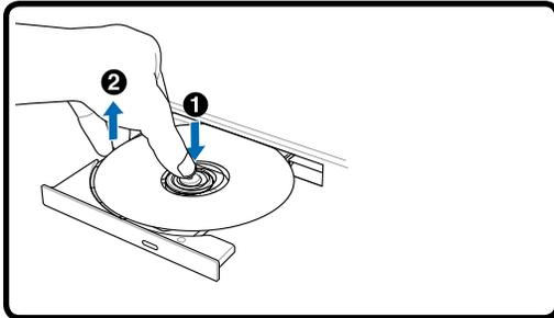
Öffnen Sie die Schublade und heben Sie den Rand der CD vorsichtig nach oben, um die CD aus der Schublade zu entfernen.
