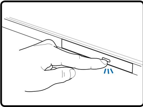
1. Drücken Sie bei eingeschaltetem Notebook die Auswurfaste, fährt der Laufwerksträger ein Stück aus.
