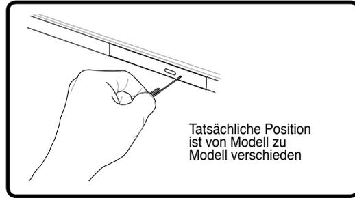
Der Notauswurf ist ein kleines Loch am optischen Laufwerk und wird dazu benutzt, die Schublade des optischen Laufwerkes zu öffnen, wenn die elektrische Öffnung nicht funktioniert. Verwenden Sie den Notauswurf nicht anstelle der elektrischen Öffnung. **Hinweis: Stechen Sie nicht in die Statusanzeige, die sich im selben Bereich befindet.**
