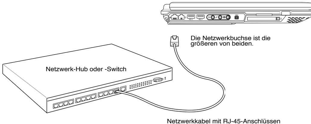
Die Netzwerkbuchse ist die größeren von beiden.
