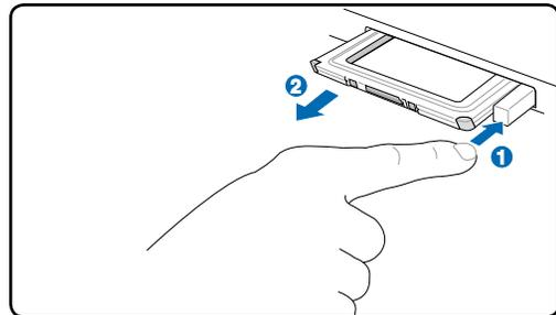
1. Drücken Sie die Auswurf-Taste hinein und lassen sie wieder los. Die Federtaste kommt heraus, wenn sie hineingedrückt und wieder losgelassen wird.
