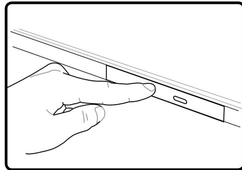
4. Drücken Sie den Laufwerksträger langsam wieder hinein. Das Laufwerk liest jetzt das Inhaltsverzeichnis auf der Disk. Wenn das Laufwerk stoppt, kann die Disk verwendet bzw. abgespielt werden.
