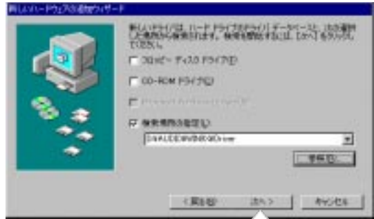
(11) サポートCDの入っているCD-ROMドライブのパス名¥AUDIO¥WIN9X¥DRIVERを入力します。次へをクリックすると最適なドライバが選択されます。
