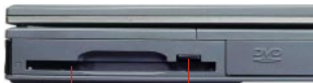
フロッピーディスクドライブ フロッピーディスク 取り出しボタン
