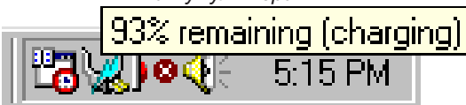
Вид значка при работе от сети. Во время зарядки на значке появится изображение молнии, которое исчезнет при полной зарядке
