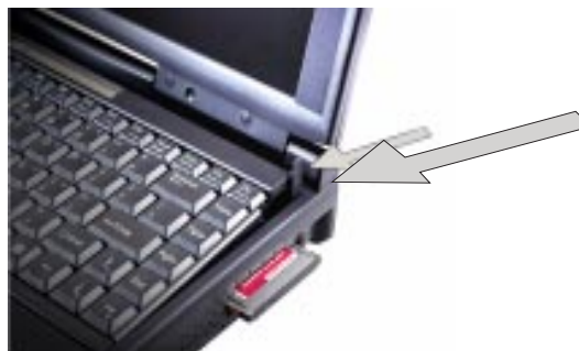
Figura 1-2: Mecanismo automático de inclinación del teclado
