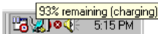
Power-Icon im Netzbetrieb. Das Lade-(Blitz) Icon erscheint nur, wenn die Batterie noch nicht vollständig aufgeladen ist.
