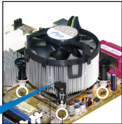
主機板孔位 散熱器與風扇的下推式固定扣具
