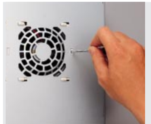
Removing or inserting the fan module
