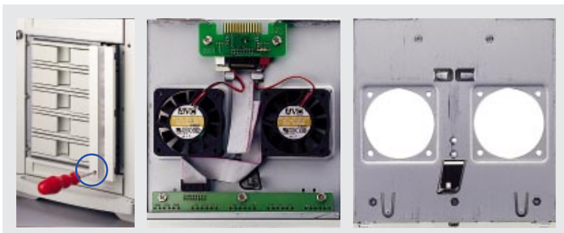
Removing the front fan module
