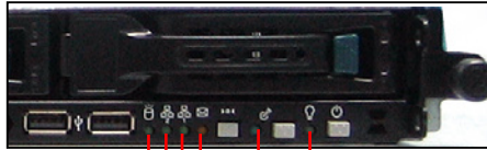
硬盘存取指示灯 LAN2 指示灯 LAN1 指示灯 信息指示灯 Location 指示灯 电源指示灯
