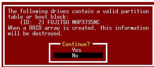
8. 完成 Array 设置后, 请确认并存储设置值。
