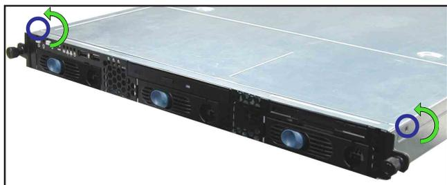
2. 接下来请将机箱上盖固定在机箱后端面板的二颗螺旋钉松开。注意：螺旋钉只需松开，不需要完全取下。
