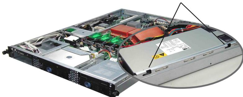
2. 将机箱上盖往前端面板方向推入，并使上盖前缘的三个卡榫完全没入前端面板内，以及将后缘两端卡榫没入上盖孔位。
