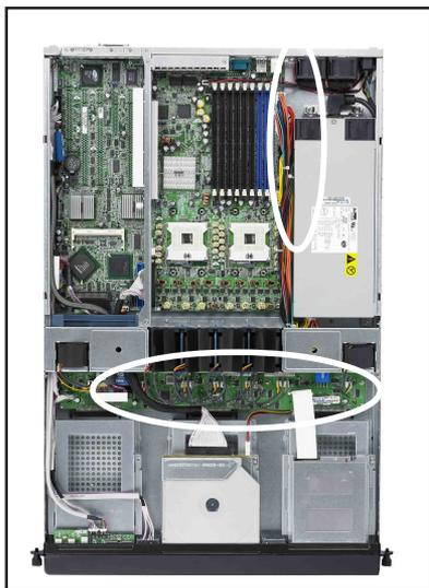
2. 先将位于机箱内的电源插头，从电源上去除。
