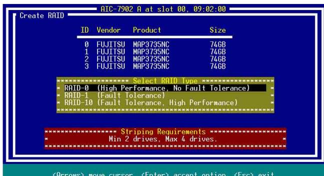
4. 利用方向键上下移动，并按下 < Space > 键选择所需要设置的硬盘，选择完毕后，按下 < Enter > 键确认。
