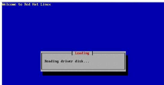
7. 安装完毕后，请选择「No」并按下 <Enter> 键直接进入 Linux 操作系统，或是若还需要安装其他驱动程序，请选择「Yes」并按下 <Enter> 键，然后再重复步骤 3~4 安装驱动程序。
