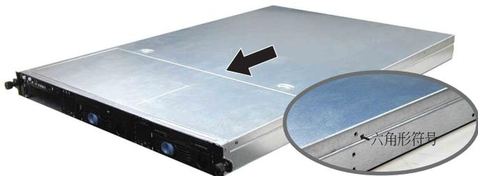
六角形符号需对准机箱左右二侧的沟槽
