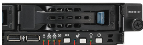
硬盘存取指示灯 LAN2/4 指示灯 LAN1/3 指示灯 讯息指示灯 Location 指示灯 电源指示灯
