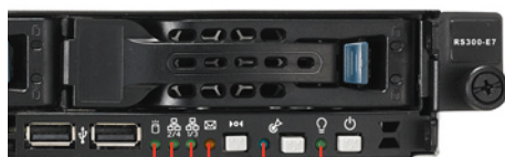
硬碟存取指示燈 LAN2/4 指示燈 LAN1/3 指示燈 訊息指示燈 Location指示燈 電源指示燈
