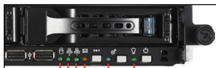
硬碟存取指示燈 LAN2 指示燈 LAN1 指示燈 訊息指示燈 Location 指示燈 電源指示燈
