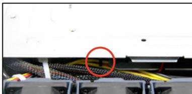
2. 将此门朝左方箭头方向推以松脱光驱，然后朝前面板方向将光驱推出机箱外，即可取出。
