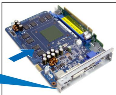
请按照以下的步骤，将装好扩展卡的转接卡装回机箱中：
