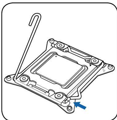
10. 接着再下压左侧固定扳手 (L)，然后朝原方向推回 (M) 并扣于固定扣上。
