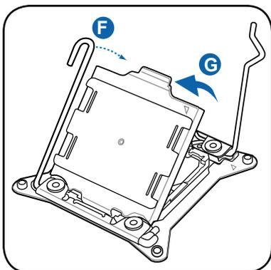
6. 请确认 CPU 上面的三角形标示是位在右下角的位置，接着把 CPU 顺着这个方向安装到主板的插槽上，并请确认 CPU 右上方缺口与插槽上对应的校准点是相吻合的。
