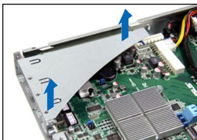
2. 将此转接卡放置在平坦的桌面上，接着请使用十字螺丝起子，将金属挡板上面的螺丝卸除。
