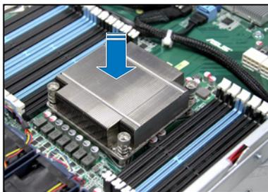
2. 将散热器上的四个螺丝，使用螺丝起子依对角的锁定方式（下图的 AA 与 BB）分别锁上，使散热器稳固于主板上。
