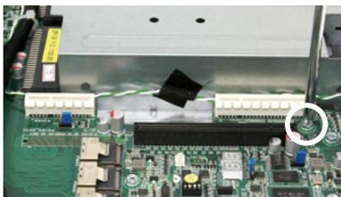
4. 取出 PIKE RAID 控制卡，并将金手指的部份对准插槽，然后压入插槽中，使金手指的部份完全没入 PIKE1/PIKE2 插槽。
