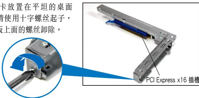
3. 然后请将 PCI Express x8 或 x16 扩展卡插入转接卡的插槽内，并锁上螺丝固定。
