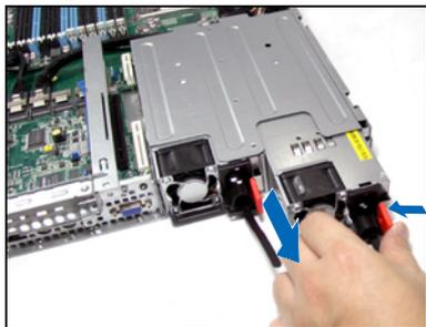
4. 将着安装一颗新的电源（PSU），推入插槽时并确保固定闩有扣入机箱中，完成安装。
