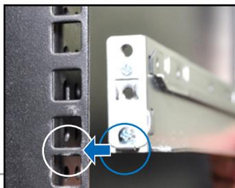
4. 将滑轨前后端各锁上两颗套有垫圈的螺丝以进行固定。
