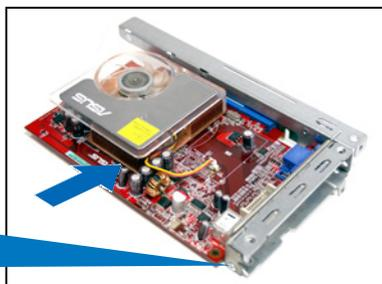
请按照以下的步骤，将装好扩展卡的转接卡装回机箱中：
