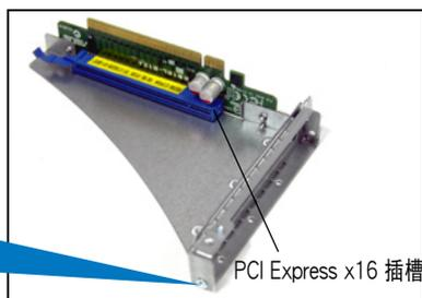
3. 然后请将 PCI Express x8 或 x16 扩展卡插入转接卡的插槽内，并锁上螺丝固定。
