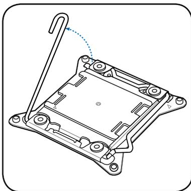
4. 接着以手指下压另一侧的固定扳手 (C)，并朝其右侧推 (D)，让扳手脱离固定扣，然后将此扳手朝箭头方向所示上推松开 (E)。
