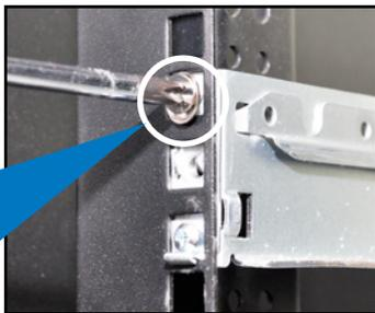
6. 当将服务器装上架架时，请确认服务器两侧已安装好可以固定服务器于滑轨上的固定扣。
