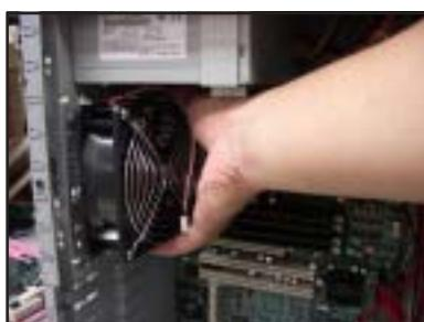
4. 接著將固定在風扇上的金屬防護罩的自攻牙螺絲卸除，就可以更換風扇。
