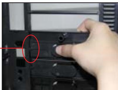
3. 在前面板的組裝方面，請將擋板凹槽如右圖正對您所安裝的硬碟機進行安裝。
