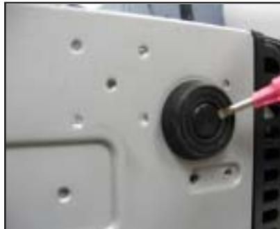
2. 接著以逆時針方向旋轉底座墊片以便將此墊片拆除。
