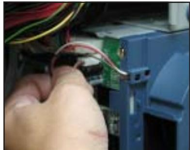
2. 然後將固定在硬碟風扇上的螺絲帽轉開卸除。
