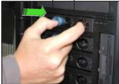
3. 握緊抽取板手並向外拉便可取出磁碟槽。
