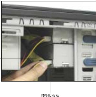
7. 最後在前面板的組裝部份，請先如右下圖所示壓下圖中的紅圈處將已安裝有 5.25 吋裝置的對應擋板拆除。
