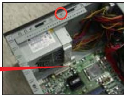
6. 將支撐架從箭頭所示的方向抽開，並從機殼中取出。
