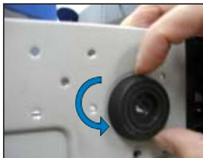
3. 拆除第一個底座墊片後，請以相同的步驟拆除剩下的底座墊片。
