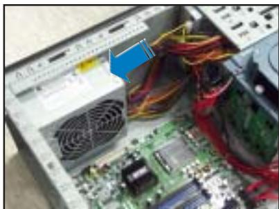
2. 從機殼後方，將電源供應器的固定螺絲鎖上。
