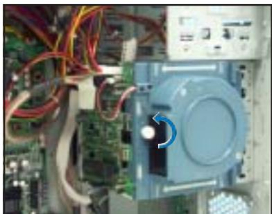
3. 然後如圖所示，將風扇用手扣住左右兩邊的塑膠卡榫，並向上且往後方拉開，取下此風扇。
