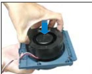
2. 接著使用十字螺絲起子，鎖上自攻牙螺絲，確實將風扇做好固定（一共有兩顆螺絲）。
