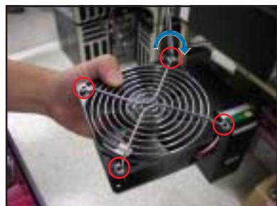
2. 將風扇置入機殼後方的定位中。
