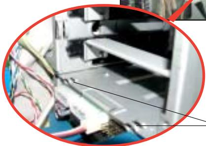
3. 確認位置後，請將背板順著凹槽滑入機殼內部，如果背板安裝正確背板的外緣將會與硬碟槽外側切齊。
