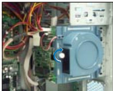
5. 再將風扇電源線連接至背板上的 3-pin 電源插座。
