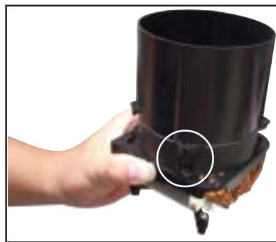
請依照以下說明來安裝 CPU 散熱器與風扇導風管組：
