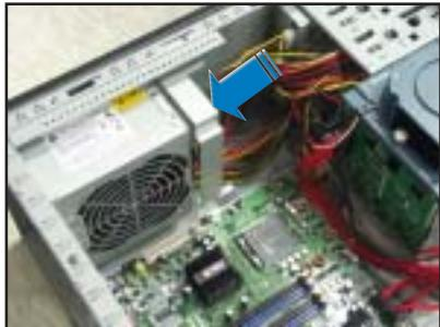
4. 如右圖所示，將支撐架上放置螺絲固定的鎖孔位置。
