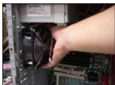
3. 接著使用十字螺絲起子，從機殼後方以自攻牙螺絲來鎖上此風扇。
