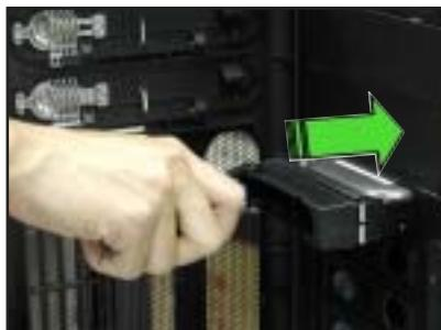
7. 最後請將板手輕輕地推回原位並輕扣固定，使抽換盒能夠緊密地固定在機殼中。如果抽換盒被正確地安裝，您將會看到抽換盒外緣與機殼呈現切齊的狀況。
