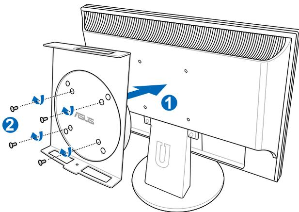
2. 請將 TC710 以正確的角度放置於 VESA 螢幕支撐架上，將螺絲對準 TC710 底部的螺絲孔位置，用螺絲起子小心地鎖緊即可。
