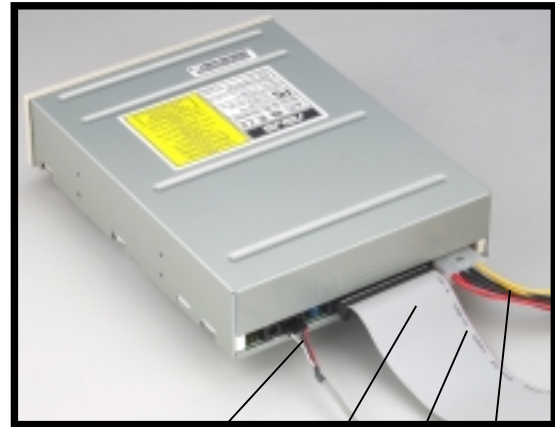
CD-ROM 音源線 IDE 排線 紅色端為第一腳位 電源線(P6)
