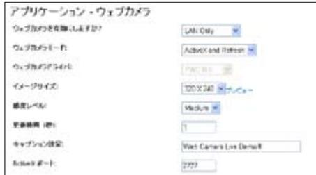
「ウェブカメラドライバ」 - ウェブカメラを無線ルータの USB 2.0 ポートに接続すると、適切なドライバが自動的に選択されます。利用可能なウェブカメラモデルについては、ASUS ウェブサイト ([www.asus.com](http://www.asus.com)) のウェブカメラサポートリストをご覧ください。
